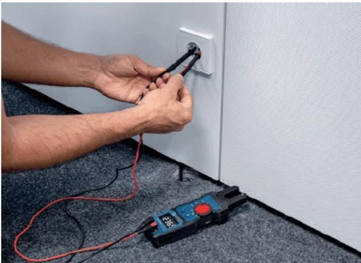
Grâce à la conception à fourche, les utilisateurs peuvent mesurer du courant jusqu'à 200 A CA sans cordons de mesure, ce qui leur offre un gain de temps. Son ouverture de mâchoire de 16 mm permet une mesure non invasive du courant alternatif. Le travail dans des zones étroites est plus rapide et ne nécessite pas de couper les circuits.
