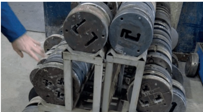
L'aluminium passe pas des filières pour créer les profilés en fonction des demandes
