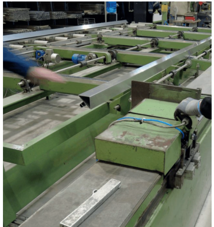
Le barretage qui permet de regrouper plusieurs composants
