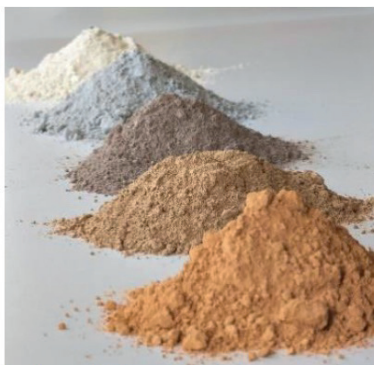
Argiles calcinées destinées aux nouveaux ciments pour développer des bétons à faible teneur en carbone avec la solution EnviroMix® C-Clay
