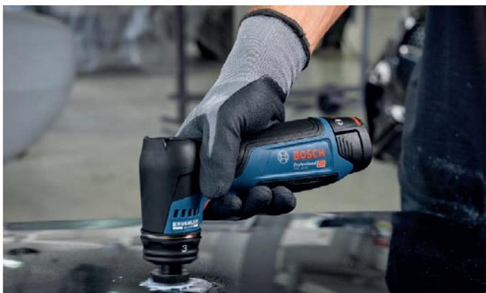
Son orbite de 3 mm et son plateau de ponçage de 32 mm garantissent un enlèvement de matière optimal. Il existe un plateau de ponçage lisse et un plateau de ponçage auto-agrippant et son changement est rapide, sans outil.
