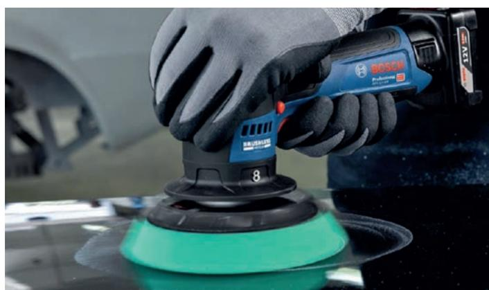
Le plateau de polissage des 2 modèles se changent facilement avec une clé plate.
