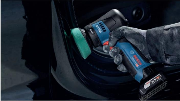
Quant à la GEX 12V-77 Professional, son plateau de ponçage de 77 mm avec interface standard se change sans outi et son orbite de 2,5 mm utilisée avec des grains plus fins offre moins d'enlèvement de matière et cible la finition.
