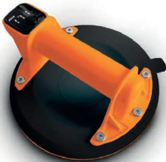
L'écran digital permet de contrôler la pression, pour plus de fiabilité et de sécurité. Grâce à sa fonction marche/arrêt automatique, la pompe s'arrête une fois la pression requise atteinte, affichant alors 200 kg à l'écran. La régulation automatique de la pression permet à la pompe de se réenclencher en dessous de 160 kg pour refaire du vide jusqu'à atteindre à nouveau 200 kg.
